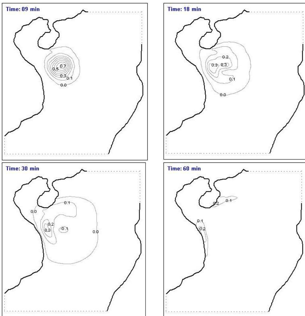
Рис. 4. Поля уровня, характеризующие распространение волны от источника А.
