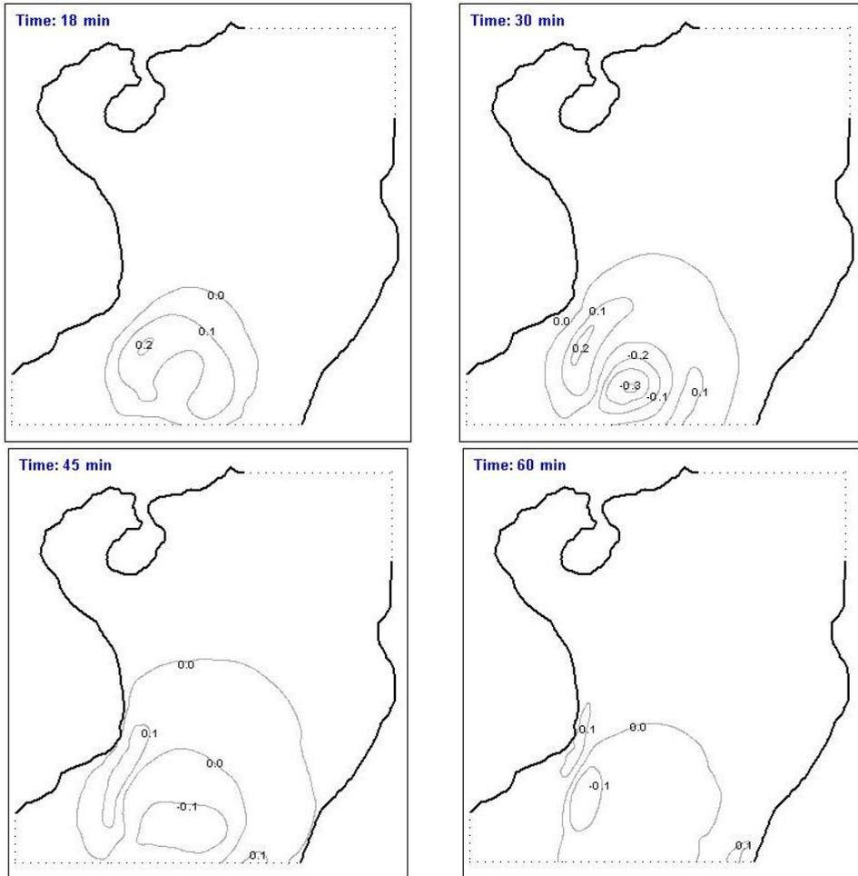
Рис. 6. Поля уровня, характеризующие распространение волны от источника С.
