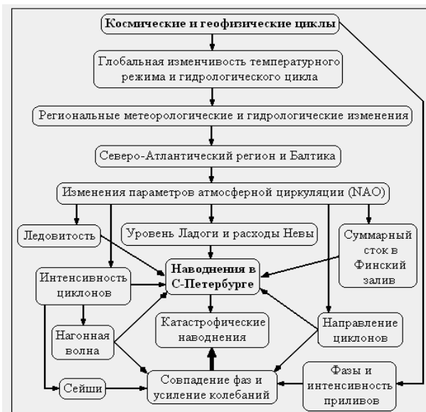
Рис. 11. Обобщенная схема причинно-следственных связей, приводящих к возникновению наводнений в Санкт-Петербурге
