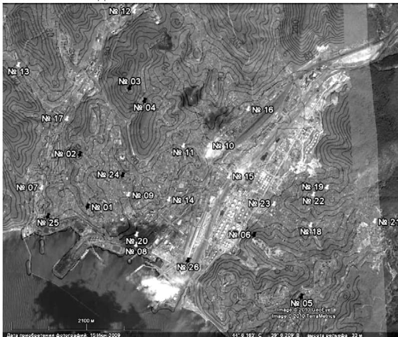
Рис. 2. Распределение опорных (черные) и маршрутных (белые) станций наблюдений за характеристиками ветра в приземном слое атмосферы на спутниковом снимке с восстановленной топографией территории поселения городского типа Туапсе в августе 2009 г.
