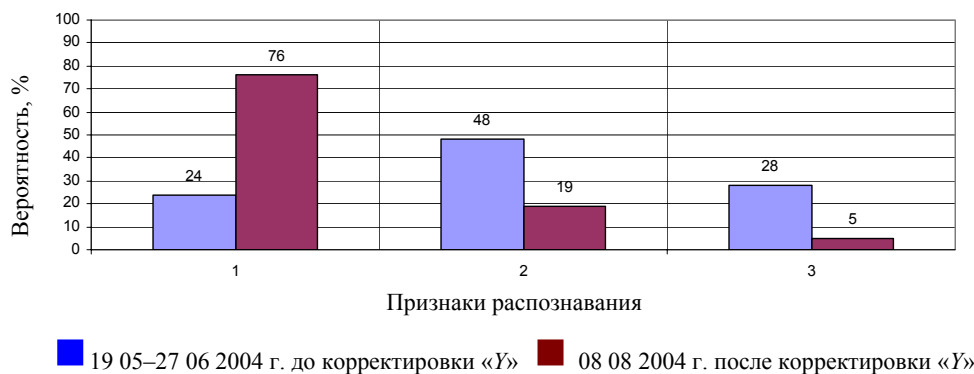
Рис. 2. Изменение вероятности правильного распознавания гроз (1), вероятности ложных тревог (2) и пропусков (3) МРЛ относительно данных пеленгатора ОГПД, совмещенного с МРЛ, до и после корректировки параметра грозоопасности «У»
