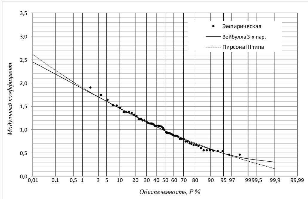
Рис. 5. Эмпирическая и аналитические кривые обеспеченностей максимальных расходов весеннего половодья р. Тверца – с. Прутенка в модульных коэффициентах ( $\bar{x} = 366$ ;  $C_v = 0,37$ ;  $C_s = 0,45$ ;  $a = 1,129$ ;  $b = 2,30$ ;  $c = 94$ )
