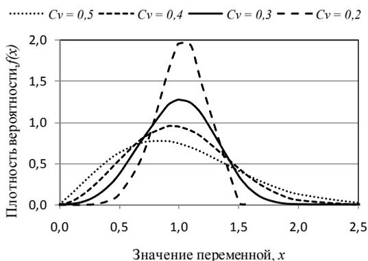
Рис. 1. Функция плотности вероятности распределения Вейбулла при различных значениях коэффициента вариации при  $m_x = 1$
