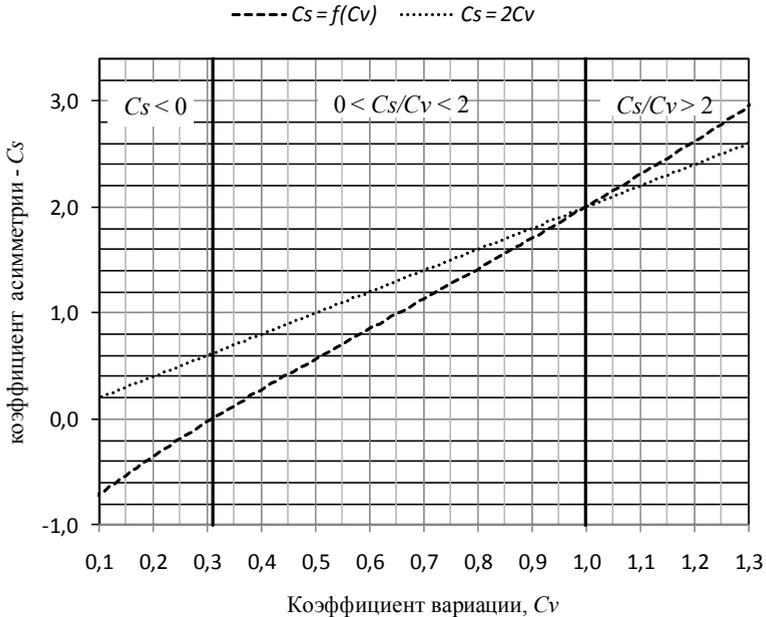
Рис. 3. Зависимость коэффициента асимметрии от коэффициента вариации для двухпараметрического распределения Вейбулла
