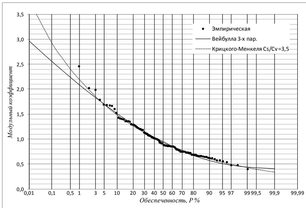
Рис. 6. Эмпирическая и аналитические кривые обеспеченностей максимальных расходов весеннего половодья р. Тихвинка – д. Горелуха в модульных коэффициентах ( $\bar{x} = 181$ ;  $C_v = 0,37$ ;  $a = 1,119$ ;  $b = 1,66$ ;  $c = 72$ )
