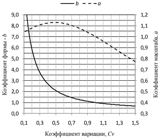
Рис. 2. Зависимость параметров двухпараметрического распределения Вейбулла ( $a$  и  $b$ ) от коэффициента вариации при  $m_x = 1$
