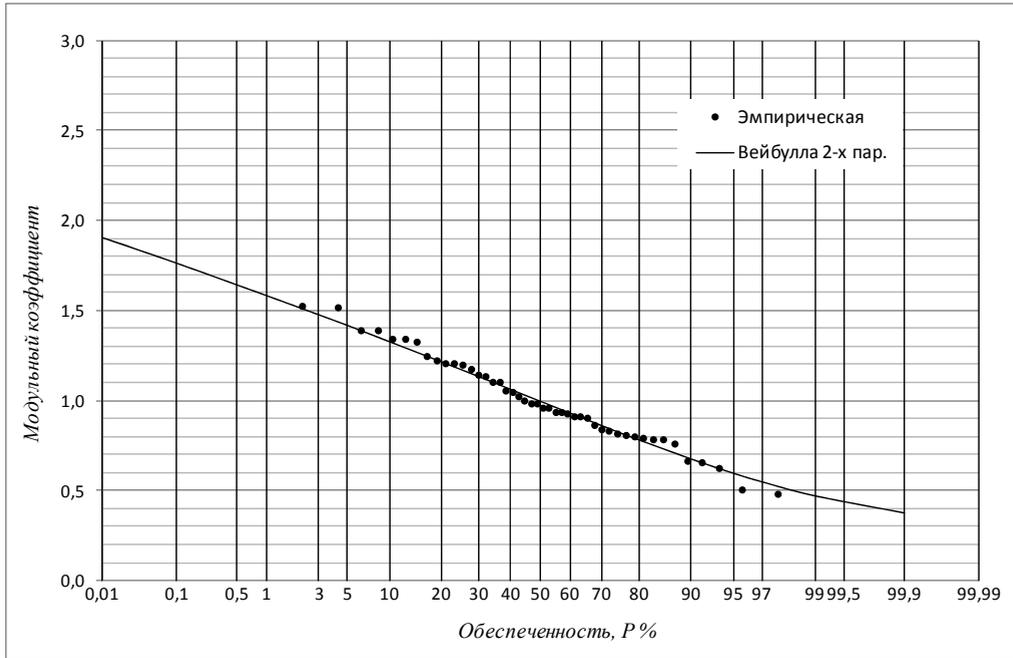
Рис. 4. Эмпирическая и аналитическая (Вейбулла) кривые обеспеченностей среднегодовых расходов воды р. Бьюн – п. Запорожское в модульных коэффициентах ( $C_v = 0,25$ ;  $a = 1,096$ ;  $b = 4,50$ )
