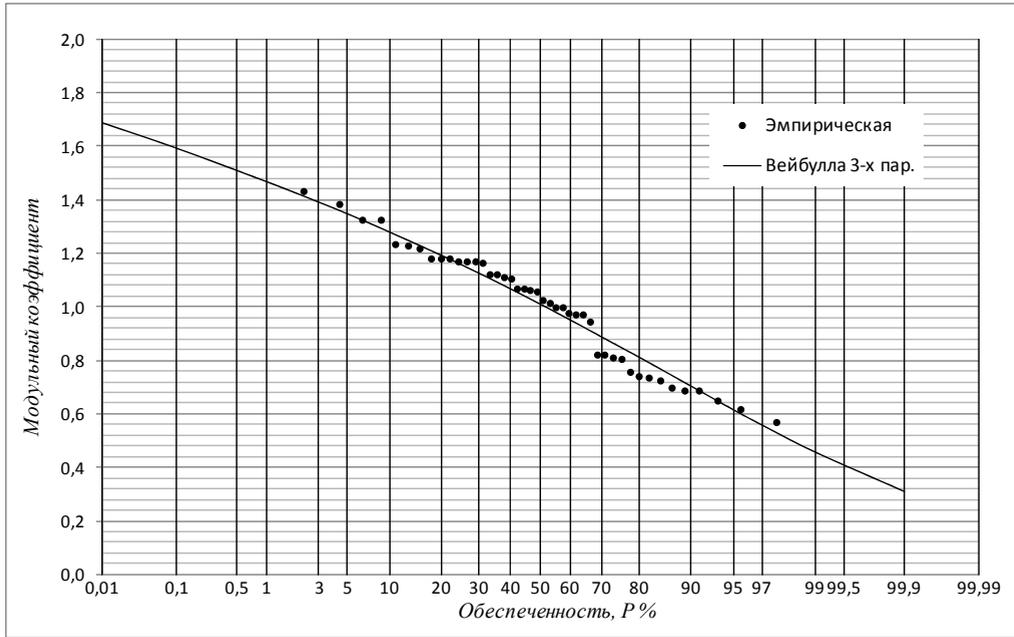
Рис. 7. Эмпирическая и аналитические кривые обеспеченностей максимальных уровней весеннего половодья р. Долгая – п. Загорье в модульных коэффициентах; «0» поста 34,05 м БС ( $\bar{x} = 150$  см;  $C_v = 0,22$ ;  $C_s = -0,22$ ;  $a = 1,092$ ;  $b = 4,75$ ;  $c = 10,8$ )
