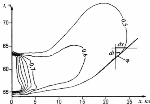
Рис. 2. Линии следования постоянной скорости течения в р. Тверце (попуск 2).
