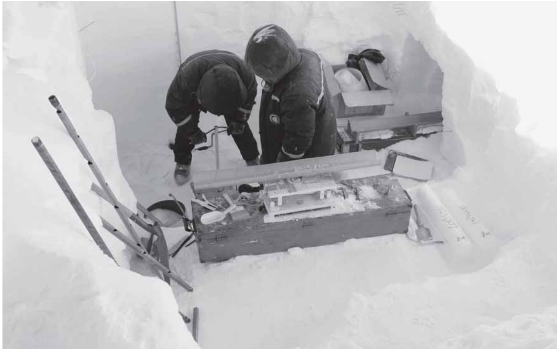
Бурение скважины глубиной 15 м в точке с координатами 78° 05' ю.ш., 102° 45' в.д., расположенной в 110 км вверх по течению льда от станции Восток
