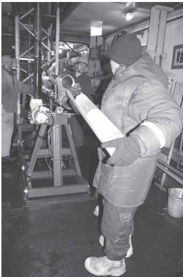
Извлечение керна льда озера Восток из керноприемной трубы бурового снаряда. Станция Восток, январь 2007 г.
