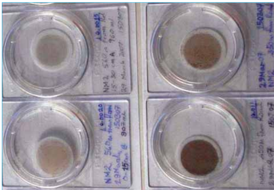
Типичные фильтры, Нарьян-Мар. Большая степень почернения означает более высокий уровень загрязнения
