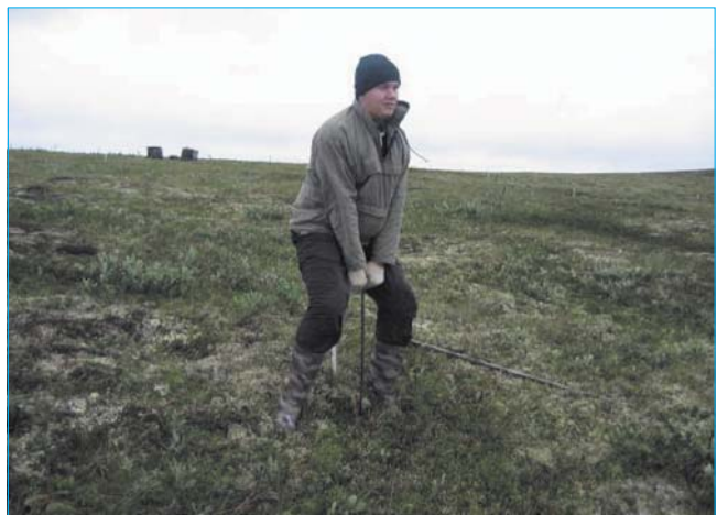
Измерение глубины протаивания при помощи металлического щупа на площадке CALM
