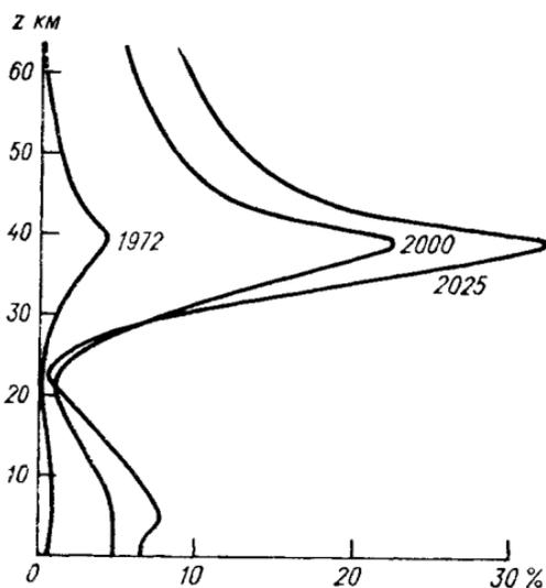
Рис 20 Уменьшение озона в результате выброса фторхлорметанов на уровне их производства в 1973 г в зависимости от высоты. Показаны результаты расчетов по модели Крутцена для 1972, 2000 и 2025 гг
