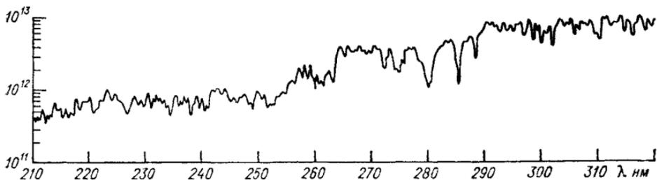
Рис 12 Интенсивность солнечной радиации в  $10^5$  фотон  $\text{м}^{-2} \text{с}^{-1} \text{нм}^{-1}$  за пределами атмосферы как функция длины волны для интервала 210–320 нм по данным Бродфута (1972) (см в [253])
