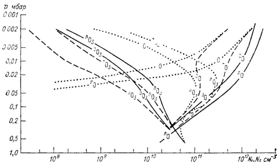
Рис 50 Рассчитанное по классической кислородной теории вертикальное распределение концентрации озона и атомарного кислорода для широты  $45^\circ$  выше 48 км. По [214]
