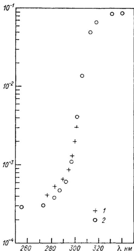
Рис. 36 Сравнение альбедных характеристик атмосферы в УФ области над экватором по данным, полученным на спутниках «Космос» (1965...1966 гг.) и «Нимбус-4» (1970 г.). Ось ординат —  $I/F_0$  в  $\text{sr}^{-1}$
