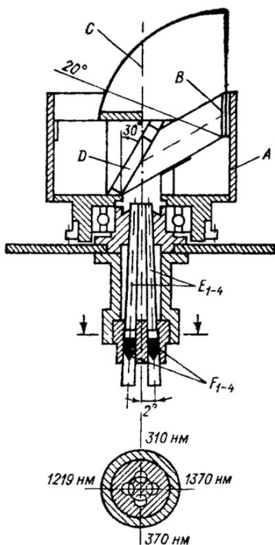
Рис 34 Схема оптического зонда Петцольда и Пискалара
