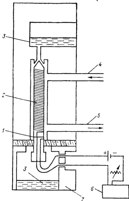
Рис 26 Электрохимический кулонометрический анализатор озона
