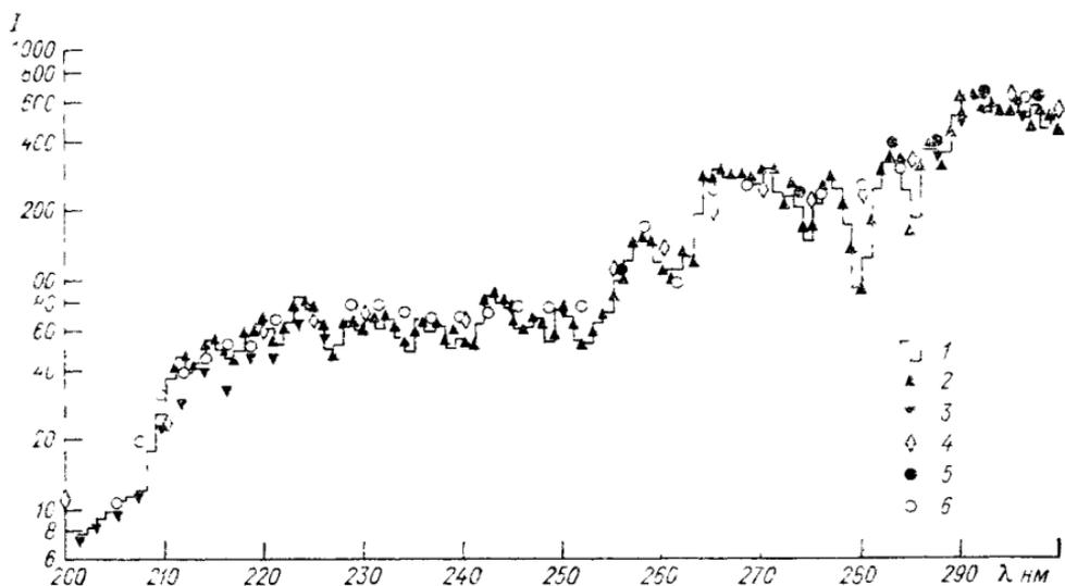
Рис 11 Интенсивность солнечной радиации в  $10^{-3} \text{ Вт} \cdot \text{м}^{-2} \cdot \text{нм}^{-1}$  за пределами атмосферы как функция длины волны в диапазоне 200 - 300 нм по данным разных авторов (см в [253])
