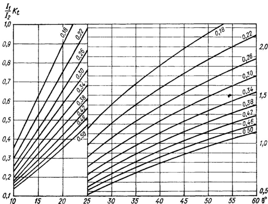
Рис. 31. Номограмма для расчета общего содержания озона по показаниям прибора М-83 (ось  $y$ ) при различных высотах Солнца (ось  $x$ )
