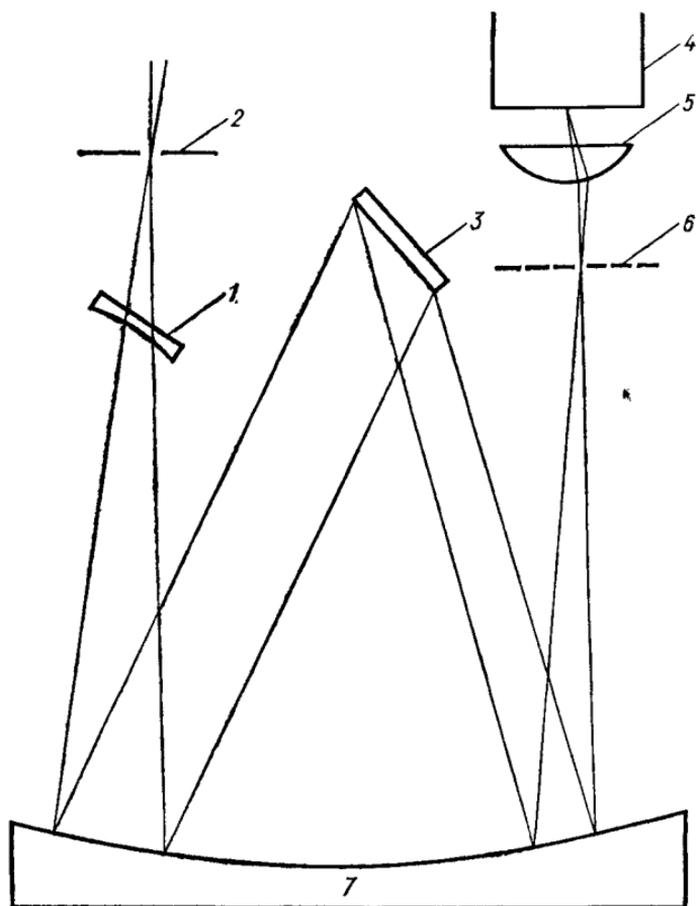
Рис 29 Оптическая схема озонметра Брюера
