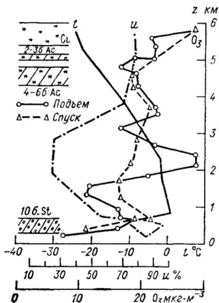
Рис 53. Вертикальное распределение плотности озона  $\rho_3$  (подъем и спуск) температуры ( $t$ ) и относительной влажности ( $u$ ) при самолетном зондировании 25 ноября 1960 г. в районе Москвы По [21]
