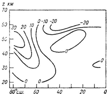
Рис. 70. Средняя меридиональная скорость воздушных течений в  $\text{м}\cdot\text{с}^{-1}$  в функции широты и высоты. Полдень, январь,  $70^\circ$  в. д. По [324]
