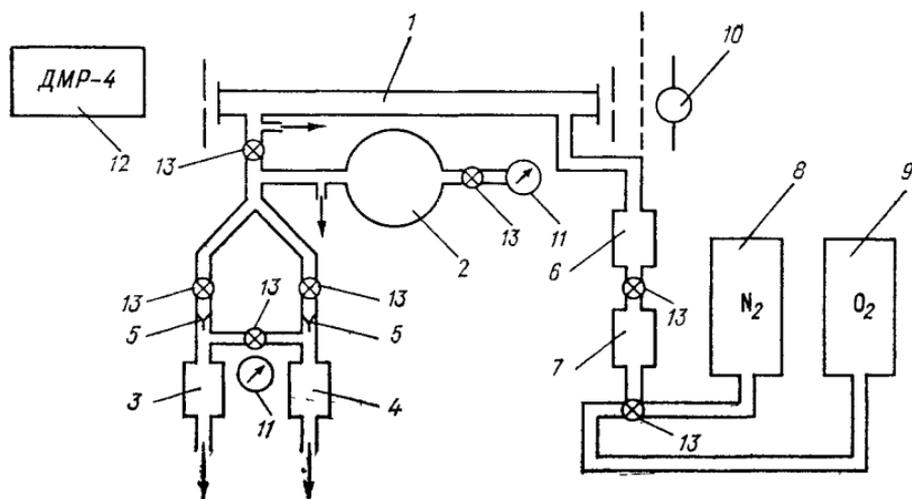
Рис 39 Вакуумная озонметрическая установка
