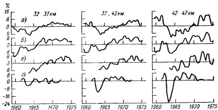
Рис 21. Временные вариации содержания озона (отклонения в процентах от среднего) в слоях стратосферы 32—37, 37—42 и 42—47 км по наблюдениям с помощью спектрофотометра Добсона методом обращения на станциях в Европе (а), Японии (б), Индии (в) и Австралии (г)
