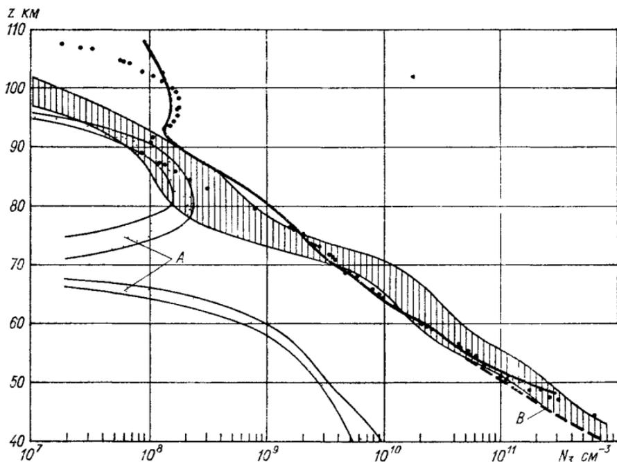
Рис 35 Сравнение профилей концентрации озона, вычисленных по наблюдениям 26 июля 1975 г (сплошная линия) и 13—14 июня 1976 г (точки) со спутника «ОАО-3 Коперникус» над экватором, с данными спутниковых измерений (A) тем же методом Хейса и Робла [249] ( $8,5^\circ$  с ш, 1973 г.) и ракетными данными (B) Хилсенрата ( $5^\circ$  с ш, 1974 г.) Заштрихованная область — результат теоретических расчетов при различных значениях констант скоростей химических реакций [399]
