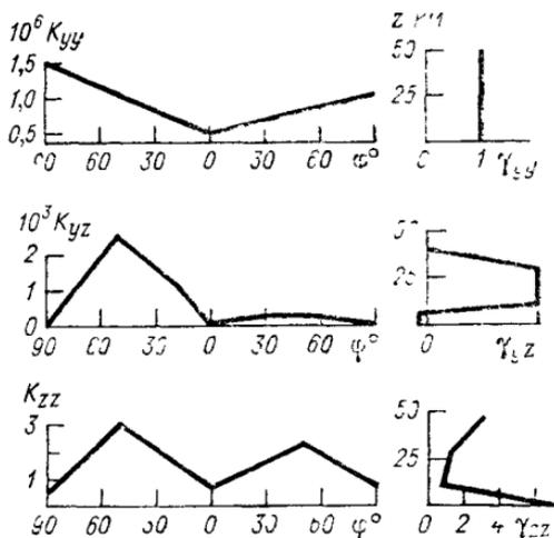
Рис 25 Зависимости коэффициентов  $K_{ij}(\lambda, 20)$  ( $\text{м}^2 \text{с}^{-1}$ ) и  $\gamma_{ij}$  (безразмерны) от широты и высоты для модели А Брасера и Бертен
