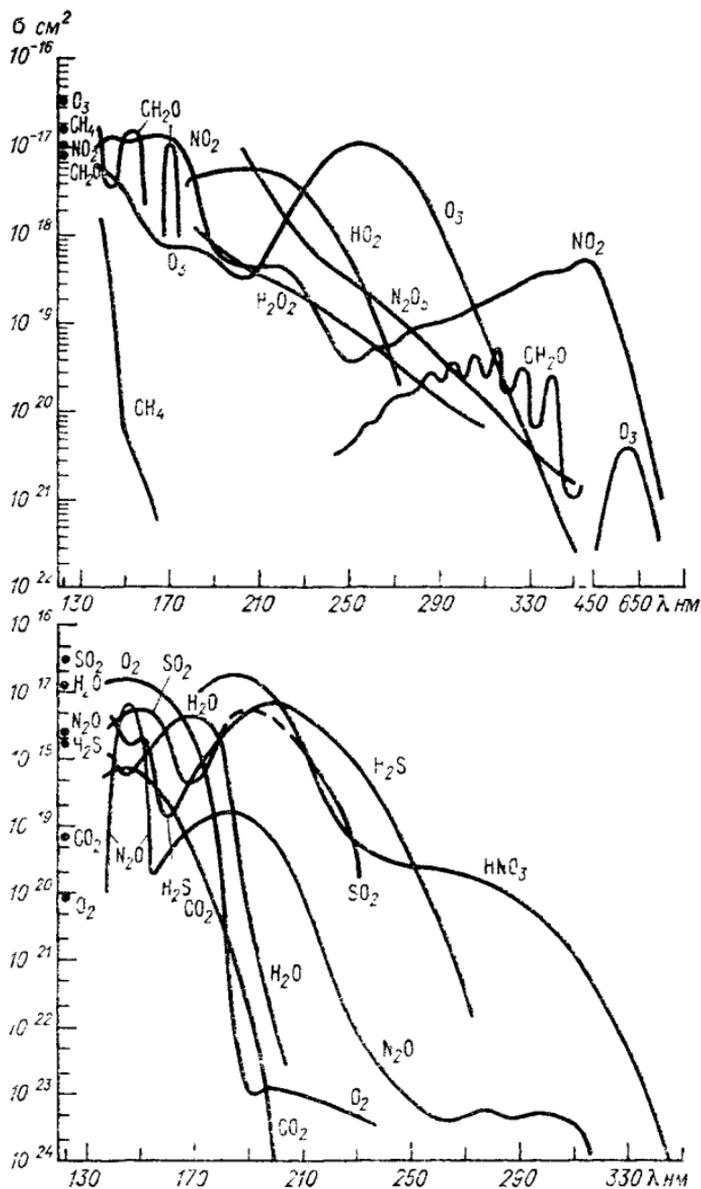
Рис 9 Сечение поглощения некоторых газов, присутствующих в атмосфере, в зависимости от длины волны. Точками отмечены  $\sigma$  указанных газов для линии  $L_{\alpha}$  ( $\lambda = 121.6 \text{ nm}$ )
