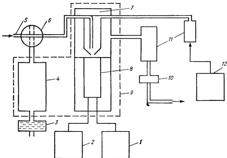
Рис. 27 Схема хемилюминесцентного анализатора озона
