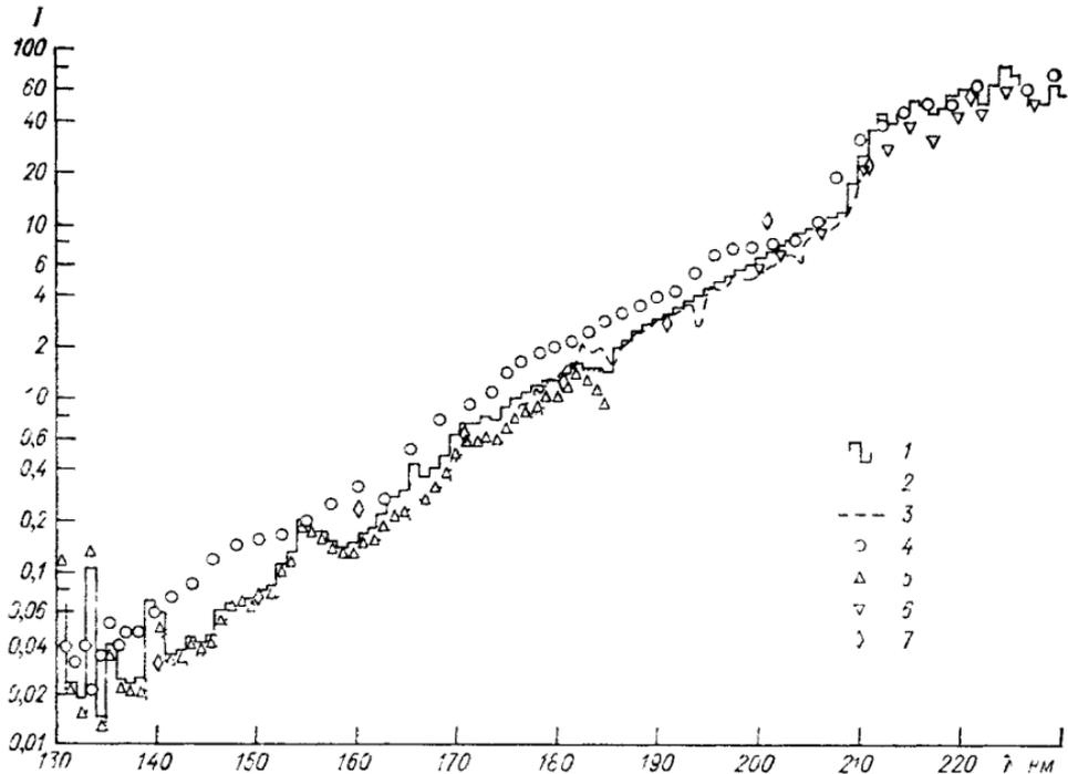
Рис 10 Интенсивность солнечной радиации в  $10^{-3} \text{ Вт} \cdot \text{м}^{-2} \cdot \text{нм}^{-1}$  за пределами атмосферы как функция длины волны по данным разных авторов (см в [253])
