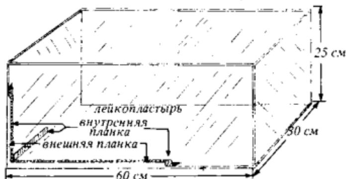
11.16. Самодельный аквариум из оконного стекла. При его изготовлении можно использовать лейкопластырь, но лучше сделать деревянную раму.
