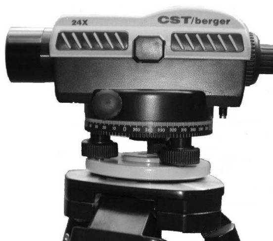
Рисунок 4 – Нивелир с компенсатором (с самоустанавливающейся линией визирования) и горизонтальным кругом CST/berger фирмы Trimble (увеличение 24X).
