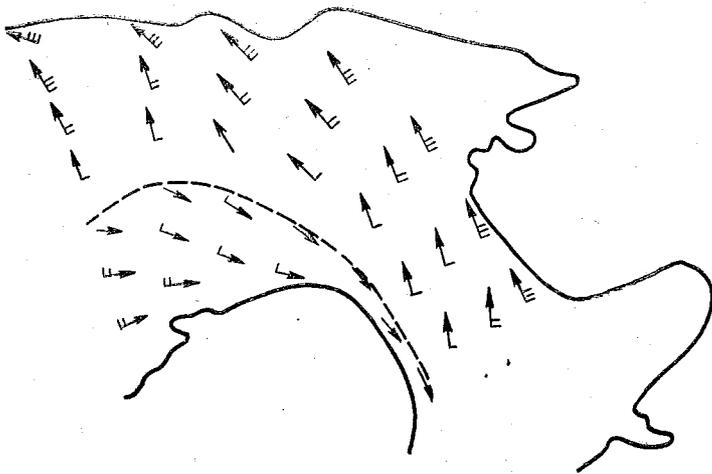
Рис. 4. Вычисленные поверхностные течения при юго-западном ветре скоростью 6 м/с. Обозначения те же, что на рис. 2
