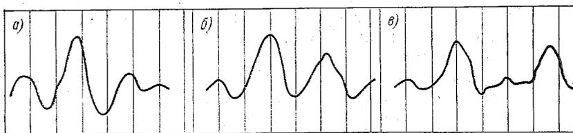
Рис. 5.16. Видеоимпульсные сигналы после широкополосного видеоусилителя.
