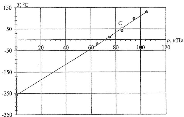
Рис. 4. График зависимости температуры газа  $t$  от давления  $p$  при постоянном объеме.
