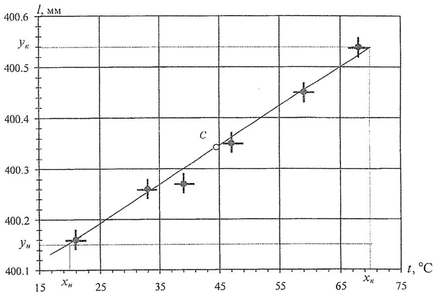
Рис.3. График зависимости длины стержня  $l$  от температуры  $t$ .
