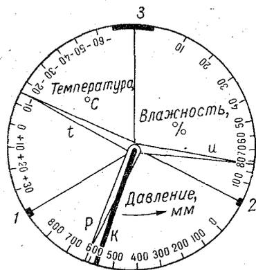
Рис. 1.3. Схема шифратора радиозонда временного способа телеизмерений.
