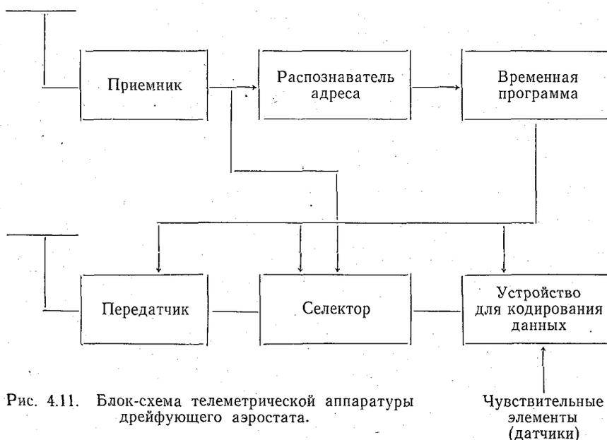
Рис. 4.11. Блок-схема телеметрической аппаратуры дрейфующего аэростата.
