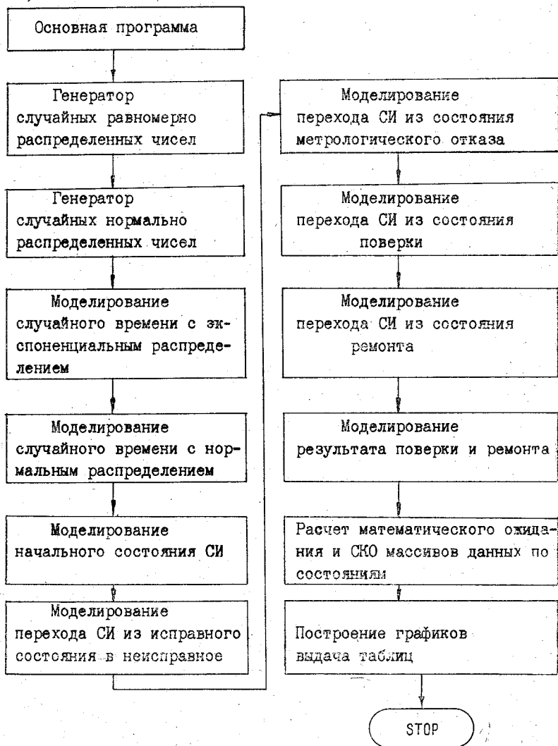
Рис. 9. Блок-схема алгоритма программы моделирования процесса эксплуатации СИ.
