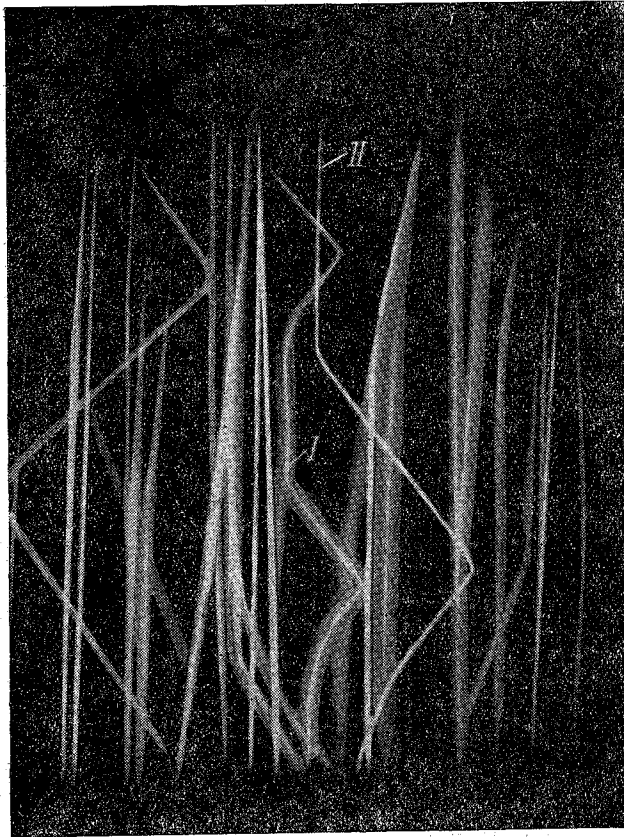
Рис. 4а. Следы капель, получившиеся при разбрызгивании воды пульверизатором.
