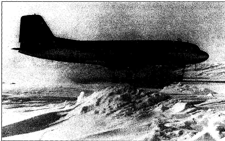
*Неутомимый труженик полярной авиации ИЛ-14 на ледовом аэродроме. Полярники так тщательно подготавливают взлетно-посадочную полосу, что самолет садится без лыж.*
