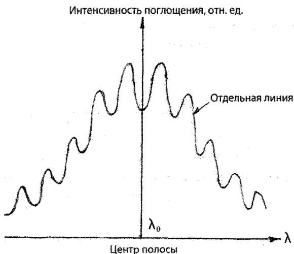
Рис. 41. Полоса поглощения (схема)
