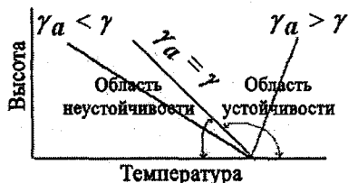
Рис. 16. Характер изменения температуры с высотой при различной устойчивости.
