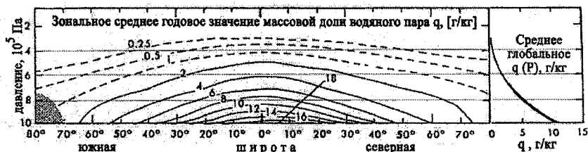
Рис. 18. Зависимость влажности воздуха от широты и высоты.
