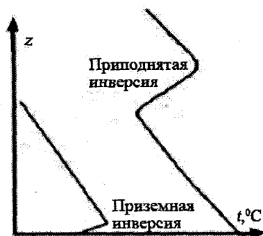
Рис. 71. Приземная и приподнятая инверсии.
