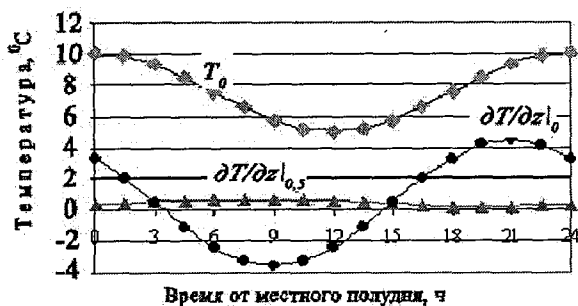
Рис. 63. Суточный ход температуры поверхности почвы и вертикального градиента температуры на поверхности почвы и на глубине 0,5 м.
