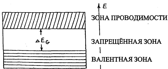
Рис. 1. Зонная структура кристаллических веществ
