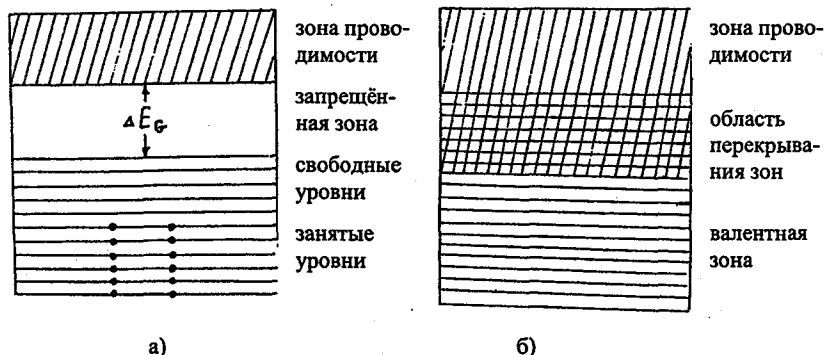
Рис. 2. Типы зонной структуры проводников
