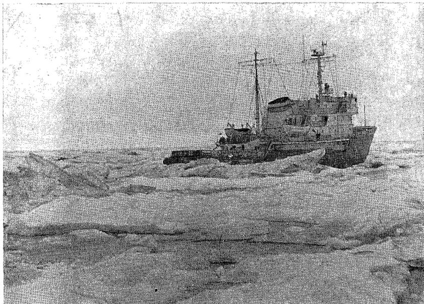
Рис. 64. Зажатое (затертое) льдом судно.
