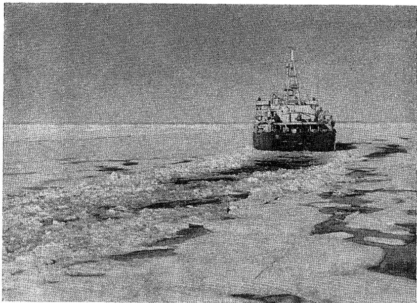
Рис. 65. Канал во льду, проложенный ледоколом.
