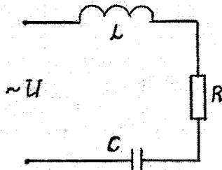
Рис. 1. Последовательное соединение элементов цепи переменного тока.
