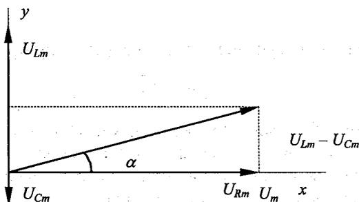
Рис. 2. Векторная диаграмма для цепи, изображённой на рис. 1.
