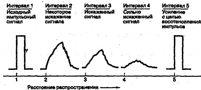
Рис. 1.1. Искажение и восстановление формы импульса.
