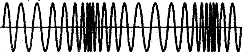
д) Частотномодулированный сигнал
