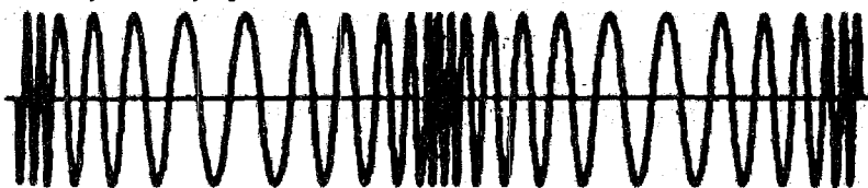
г) Фазомодулированный сигнал
