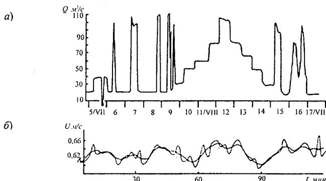
Рис. 3.6. График попусков на р. Тверце (а) и скорость, измеренная на вертикали № 3 в гидрстворе № 1 8/VIII 1959 г. с 12 ч 34 мин до 14 ч 34 мин до и после скользящего осреднения (б).
