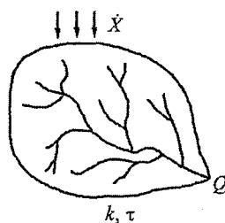
Рис. 4.2. К модели формирования речного стока с сосредоточенными параметрами (4.2).
