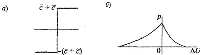
Рис. 4.12. Характер нелинейности (а) и распределения плотности вероятности (б) для модели (4.15).
