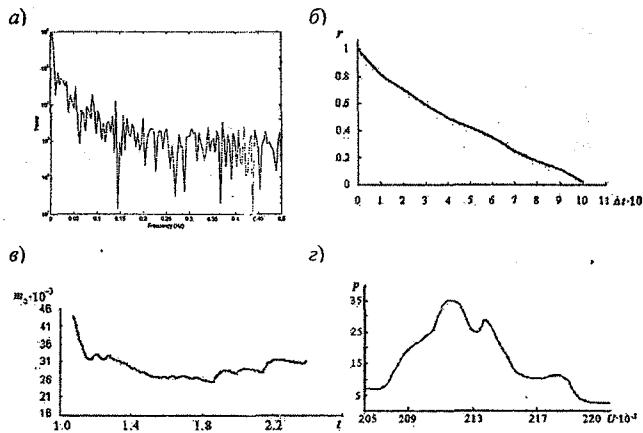
Рис. 3.4. Спектр (а), автокорреляционная функция (б), зависимость  $m_2 = f(t)$  (с) и толстохвостое распределение плотности вероятности  $p(U)$  (д), вычисленные по реализации, представленной на рис. 3.3, б.
