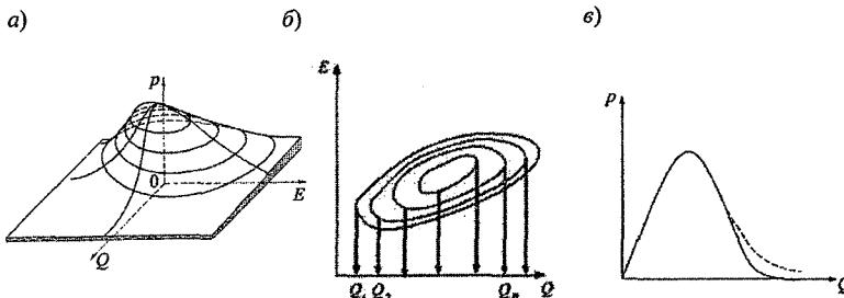
Рис. 4.13. Двумерное распределение плотности вероятности  $p(Q, E)$  (а), его двумерная (б) и одномерная (в) проекции (стрелками на рис. б условно показано проектирование эмпирических точек с координатами  $(Q, E)$  на ось расходов; рис. в – это результат статистической обработки ряда  $Q_1, Q_2, \dots, Q_n$ ).
