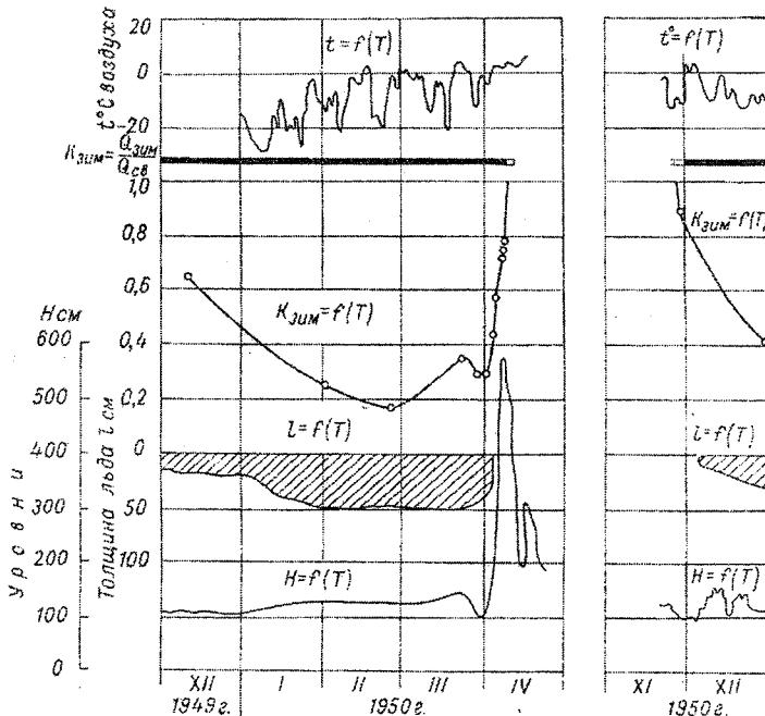
Рис. 3.7. Пример хронологических графиков, используемых в методе переходных зимних коэффициентов [10].
