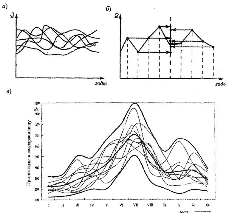
Рис. 5.4. Гипотетический стационарный пучок годовых расходов воды (а), механизм получения его сечения (б) и нестационарный пучок месячного притока воды в водохранилище Бэтания (р. Магдалена, Колумбия) (в).
