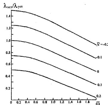
Рис. 2.6. Зависимость отношения неустановившегося  $\lambda_{\text{нест}}$  и установившегося  $\lambda_{\text{уст}}$  значений коэффициентов гидравлических сопротивлений  $\lambda_{\text{нест}}/\lambda_{\text{уст}}$  от безразмерных частоты  $\bar{\omega}$  и ускорения  $N$ .
