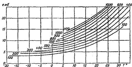
Рис. 4.17. График для расчета годового испарения (мм/год) по среднегодовым температурам ( $T^{\circ}\text{C}$ ) и влажности воздуха ( $e \text{ мбар}$ ).
