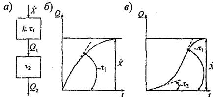
Рис. 5.7. Схема двухъемкостной структуры формирования стока (а), реакция однокомпьютерной (б) и двухъемкостной (в) модели на «ступенчатое» воздействие осадков (тангенсы углов наклона пропорциональны временам релаксации  $\tau_1$  и  $\tau_2$ ).
