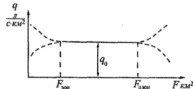
Рис. 4.7. Зависимость модуля стока  $q$  от площади водосбора  $F$  ( $F_{\text{azon}} < 1000 \text{ km}^2$  – азональное,  $F_{\text{azon}} > 50000 \text{ km}^2$  – полизональное значения площадей).
