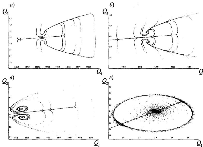
Рис. 5.8. Возникновение стохастических двумерных колебаний при сближении численных значений емкостей  $Q_1^0 / Q_2^0$ .
