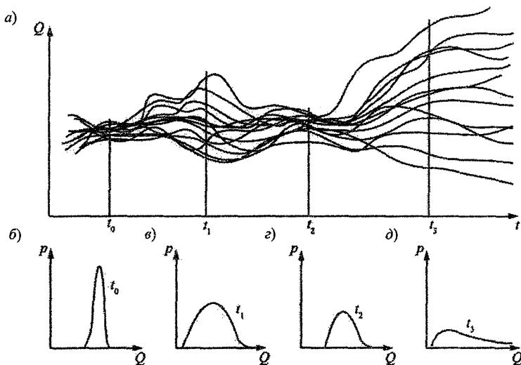
Рис. 5.3. Случайный процесс («пучок траекторий») (а), а также устойчивые (б, в, г) и неустойчивое по дисперсиям сечения «пучка» (д).
