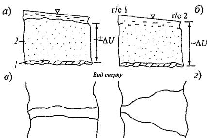
Рис. 5.1. Слияние речного стока с зоной аэрации (а) и превращение двух последних в «псевдоводоем» (б) за счет либо роста со-противлений в г/с 2 (например, затор), либо за счет увеличения поступления осадков  $X$  на водосбор и повышения расхода воды в г/с 1.
