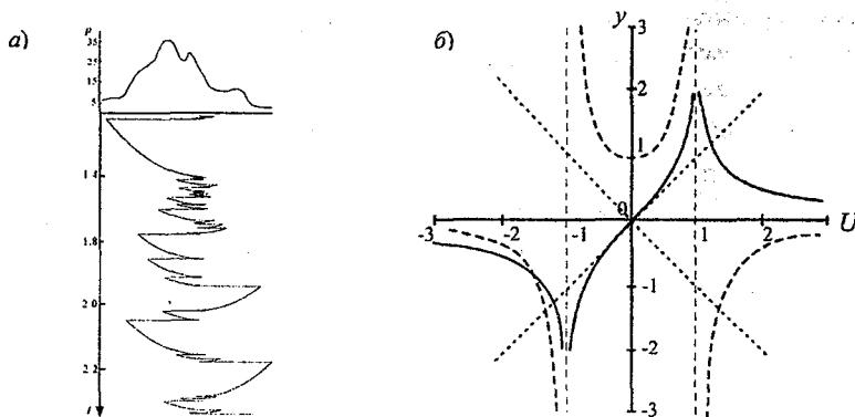
Рис. 3.8. Возможный вариант решения уравнения (3.6) при нулевой интенсивности внешних и взаимных шумов (соответствует временной развертке и плотности вероятности из п. 3.1) (а) и графики функций  $y = 1/(1-U^2)$  (пунктир),  $y = 0,5 \ln|(1+U)/(1-U)|$  (сплошная линия) и  $y = \pm U$  (точки) (б).
