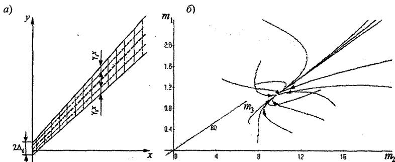
Рис. 3.9. Полоса неопределенностей (а) и стремление решения системы (3.9) к устойчивому состоянию при  $\beta = G_{\bar{c}} / c < 0,5$  (б).
