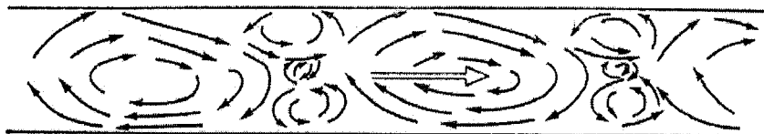
Рис. 1.8. Схема кинематической структуры потока, (по М.А. Великанову).
