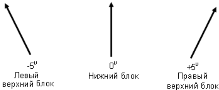
Рисунок 5.11 – Углы веерности направляющих в блоках ПУ «Элия-МР»
