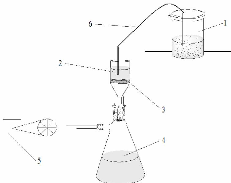
1 – проба воды; 2 – воронка для фильтрации; 3 – фильтр; 4 – колба Бунзена; 5 – вакуумный или водоструйный насос; 6 – трубки соединительные.
