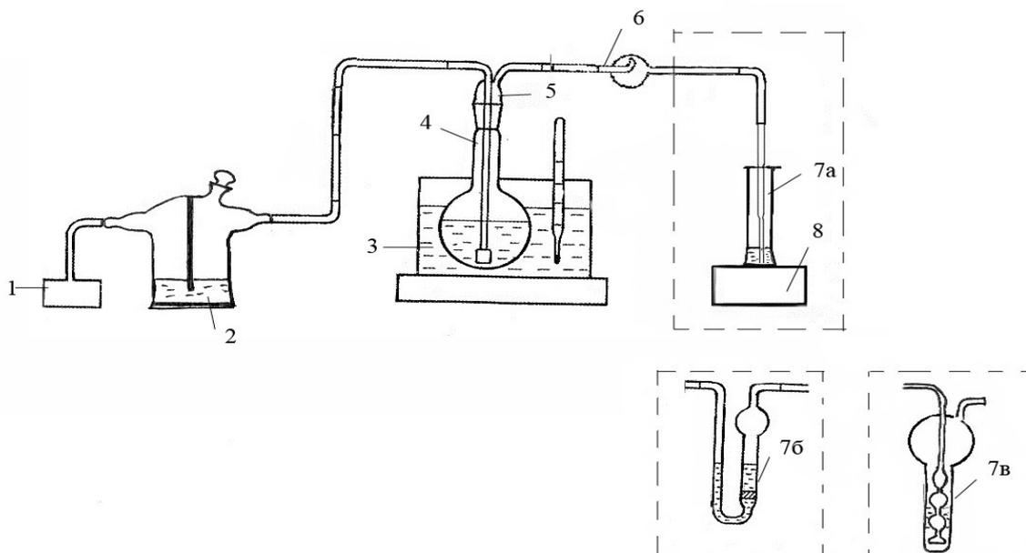
1-микрокомпрессор; 2 – склянка для промывания газов СПЖ; 3 – водяная баня с терморегулятором; 4 – круглодонная колба; 5 - насадка к склянке для промывания газов  $\text{CH}_4$ ; 6 - каплеуловитель; 7 – поглотительный сосуд (7а - цилиндр мерный с пипеткой Пастера, 7б – поглотитель с пористой пластиной, 7в – поглотитель Рихтера); 8 – подставка
