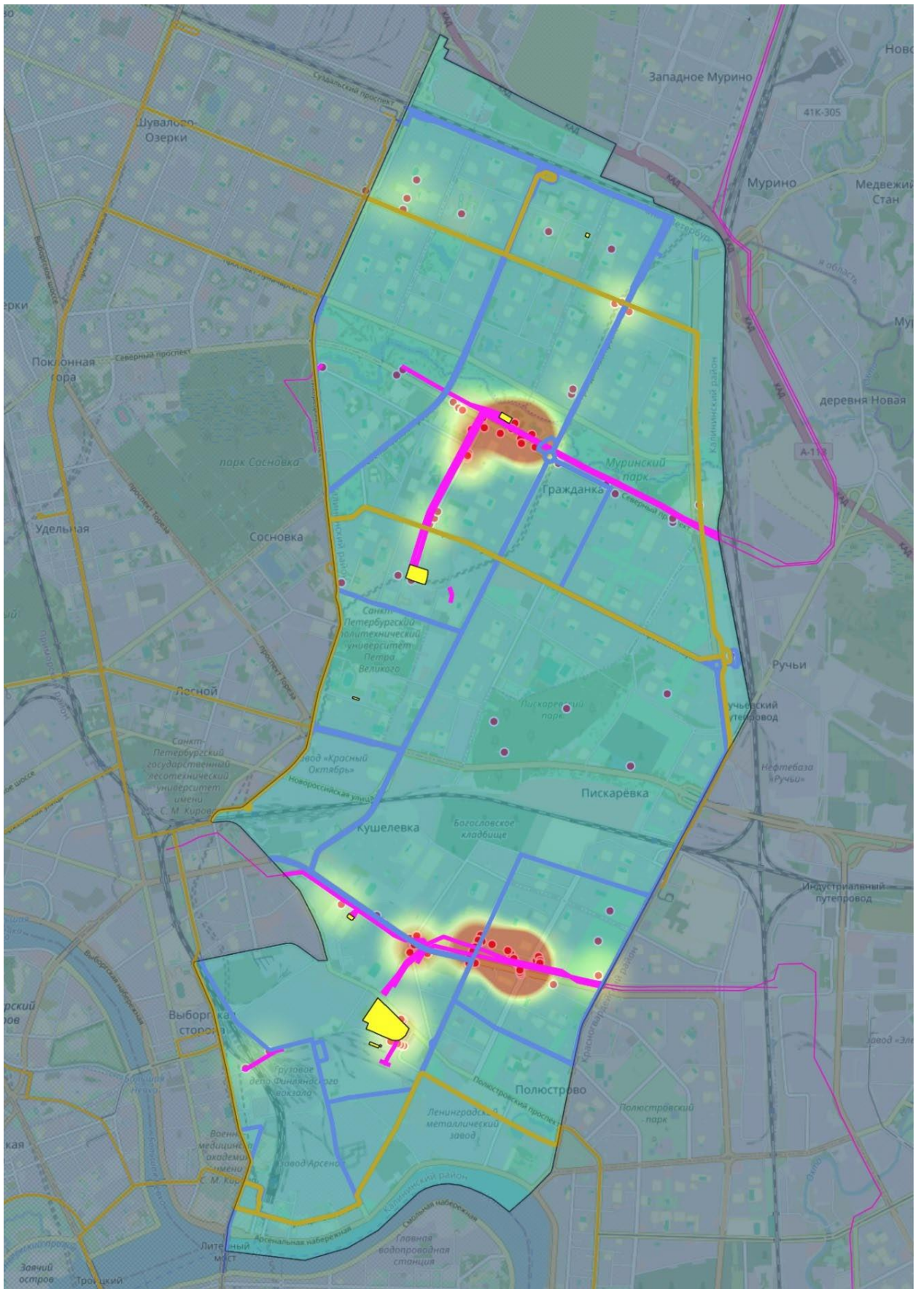
Рисунок 3.2.3 – Тепловая карта магнитного излучения \mu\text{T} на высоте 0,2м
