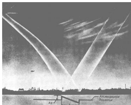
Рис. 2.1. Схематическое изображение акустической волны, генерируемой сверхзвуковым движением ракеты и его отражение от земной поверхности
