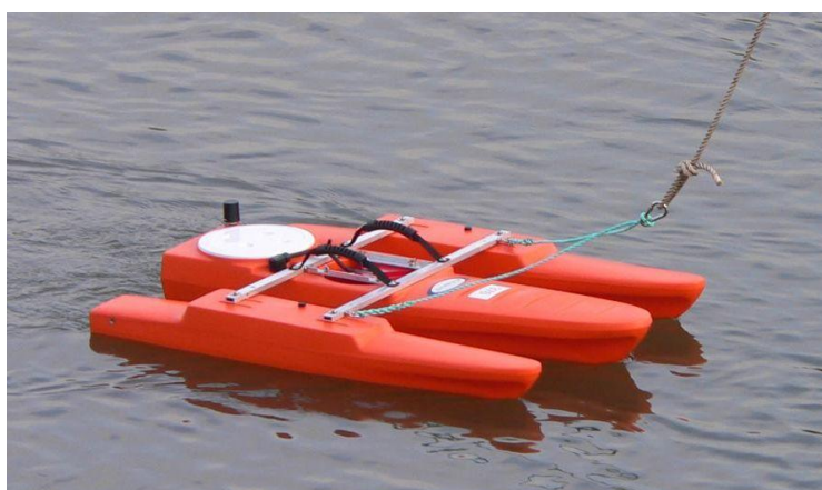
Рис. 1.4 Тримаран акустического доплеровского профилографа WHRioGrande
