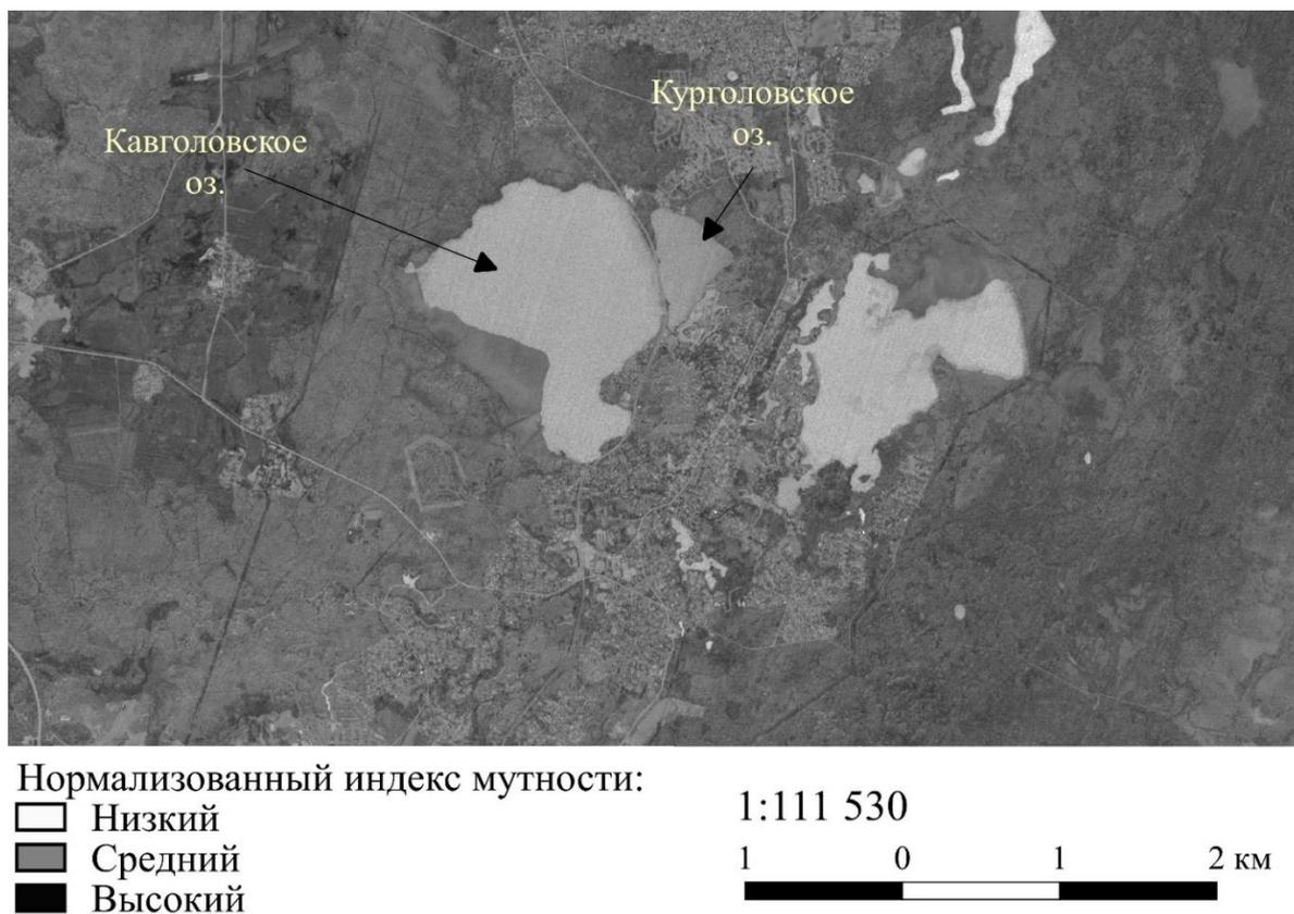
Рисунок 4.1 – Результат расчёта нормализованного индекса мутности для участка земной поверхности с исследуемыми озёрами за 04.08.2023 г.
