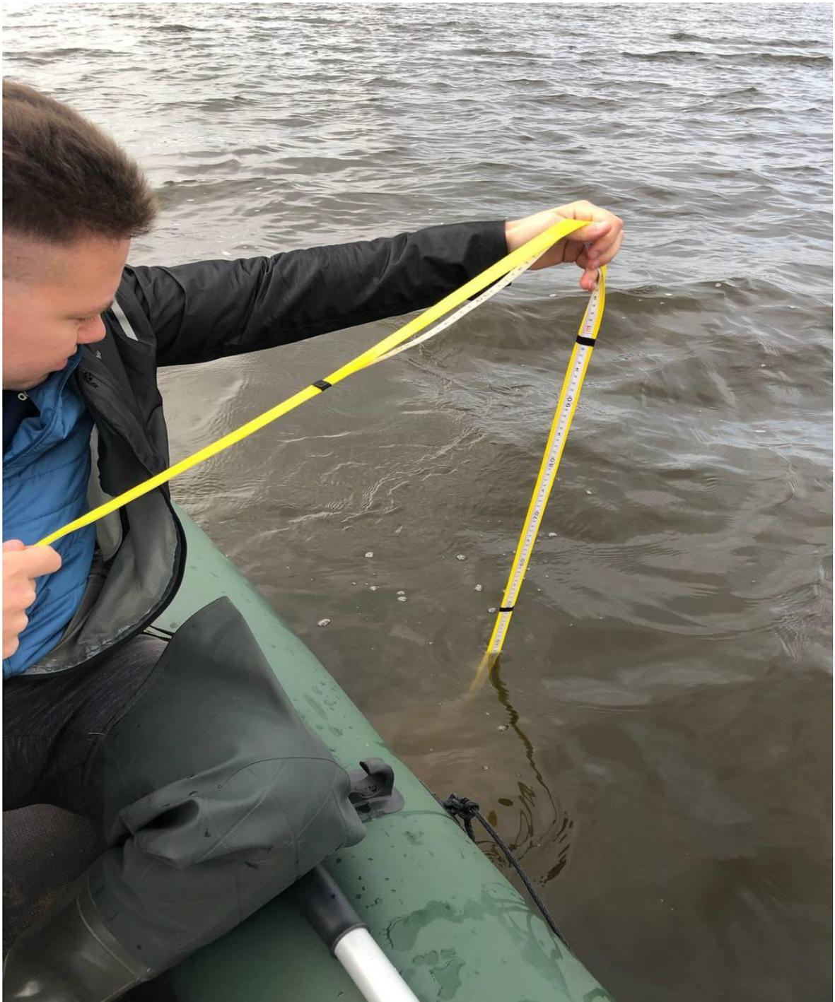
Рисунок 3.6 – Процесс измерения величины прозрачности на озере
