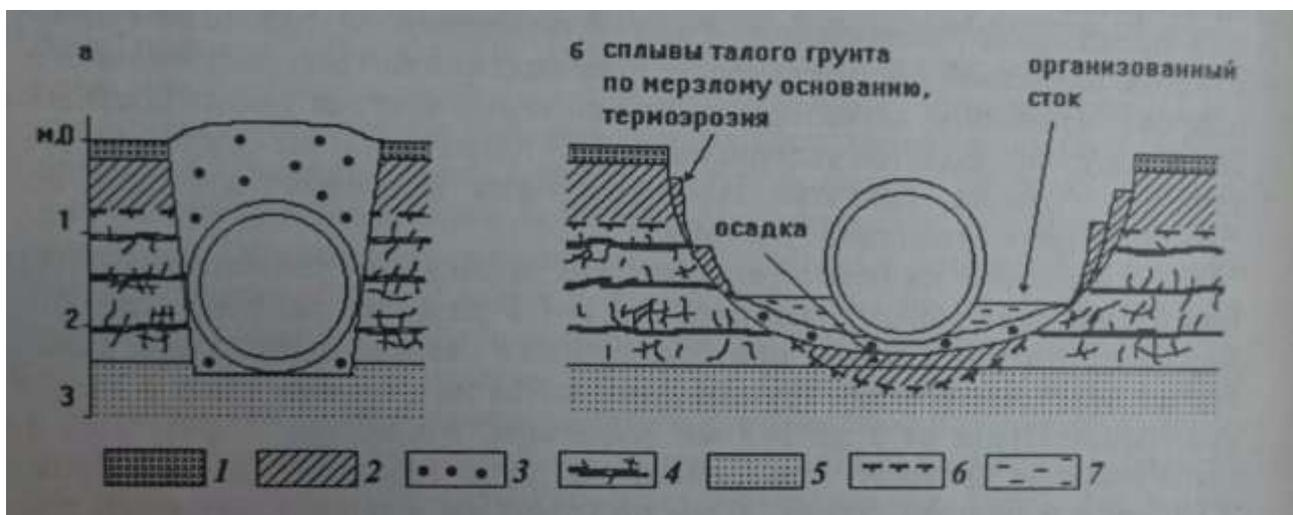
Рисунок 15. Профиль траншеи подземного газопровода: а – проектный; б – через два года после строительства
