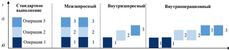
Рис. 5.5. Виды параллелизма обработки данных
