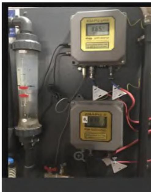
Рисунок 8 – Прибор кондуктомер « КВАРЦ -2»
