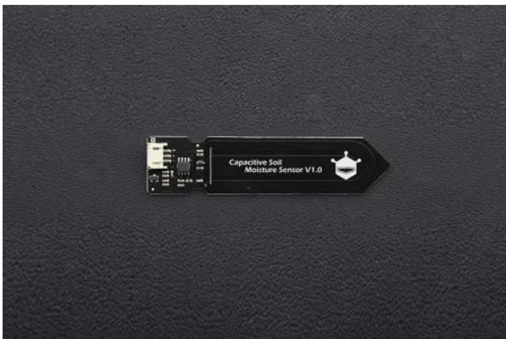
Рисунок 3.6 - Датчик влажности почвы SEN0193
