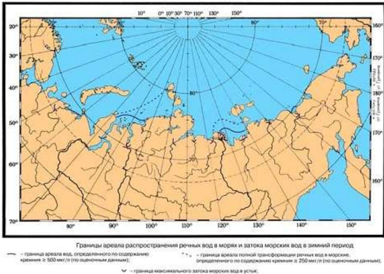
Рис. 1.2 Граница ареала распространения речных вод в морях и затока морских воды в зимний период
