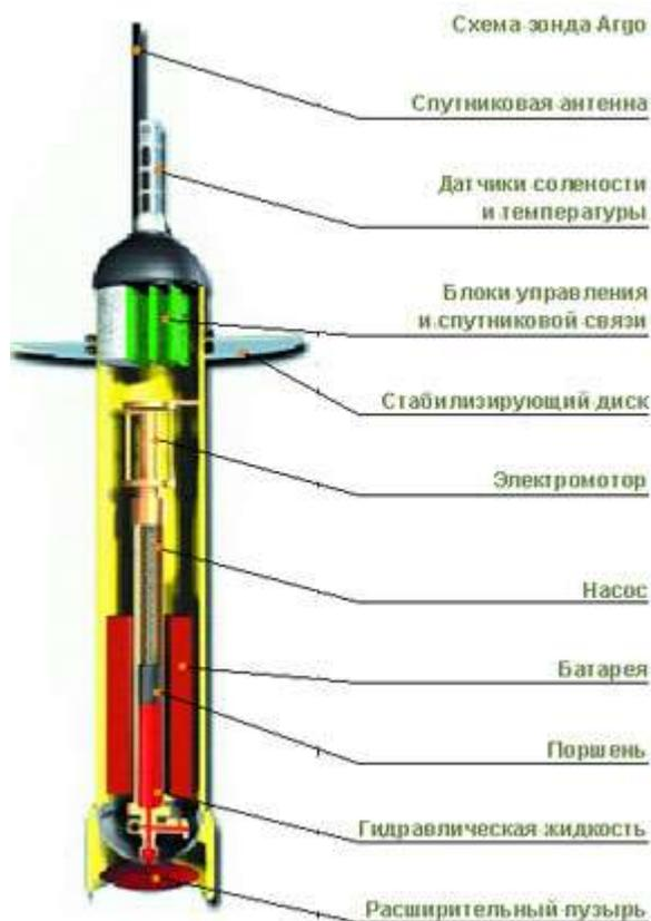
Рис.2.4 Схематическое изображение буя АРГО
