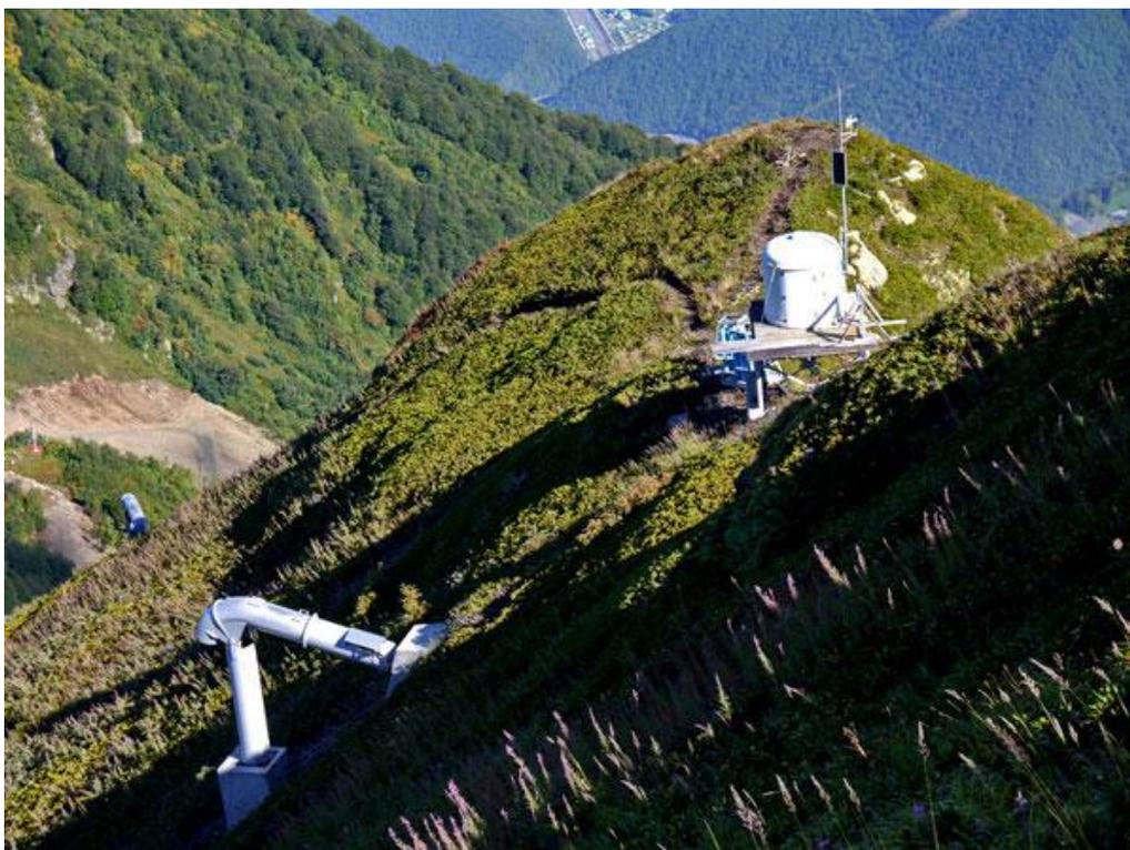
**Рис. 32. Шелтор и Эксплодер системы газекс<sup>19</sup>**
