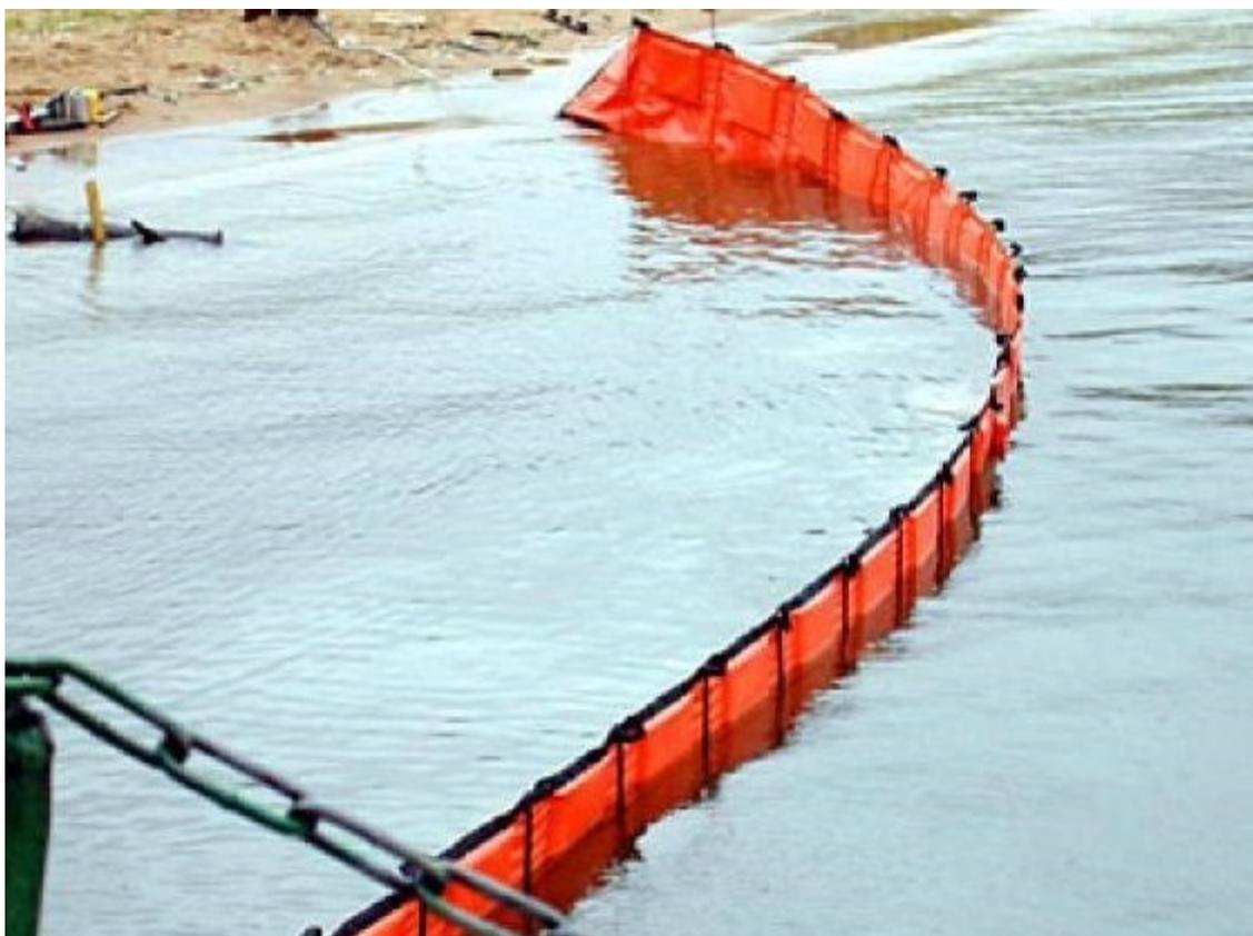
Рисунок 2.1 – Боновые заграждения постоянной плавучести
