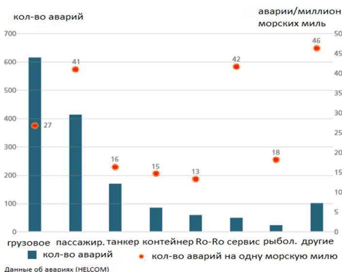
Рисунок 1.17 – количество аварий в Балтийском море с 2011 по 2015 гг. и количество аварий на одну морскую милю
