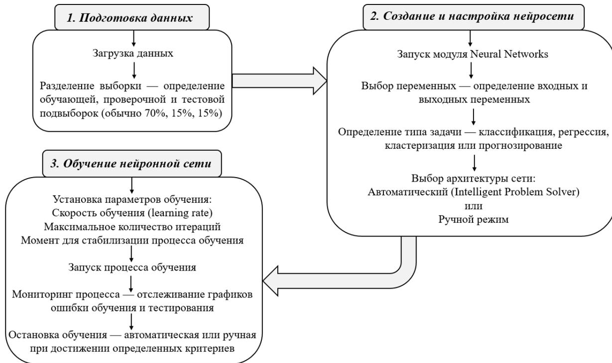
Рисунок 2.5. Схема пошагового использования SNN
