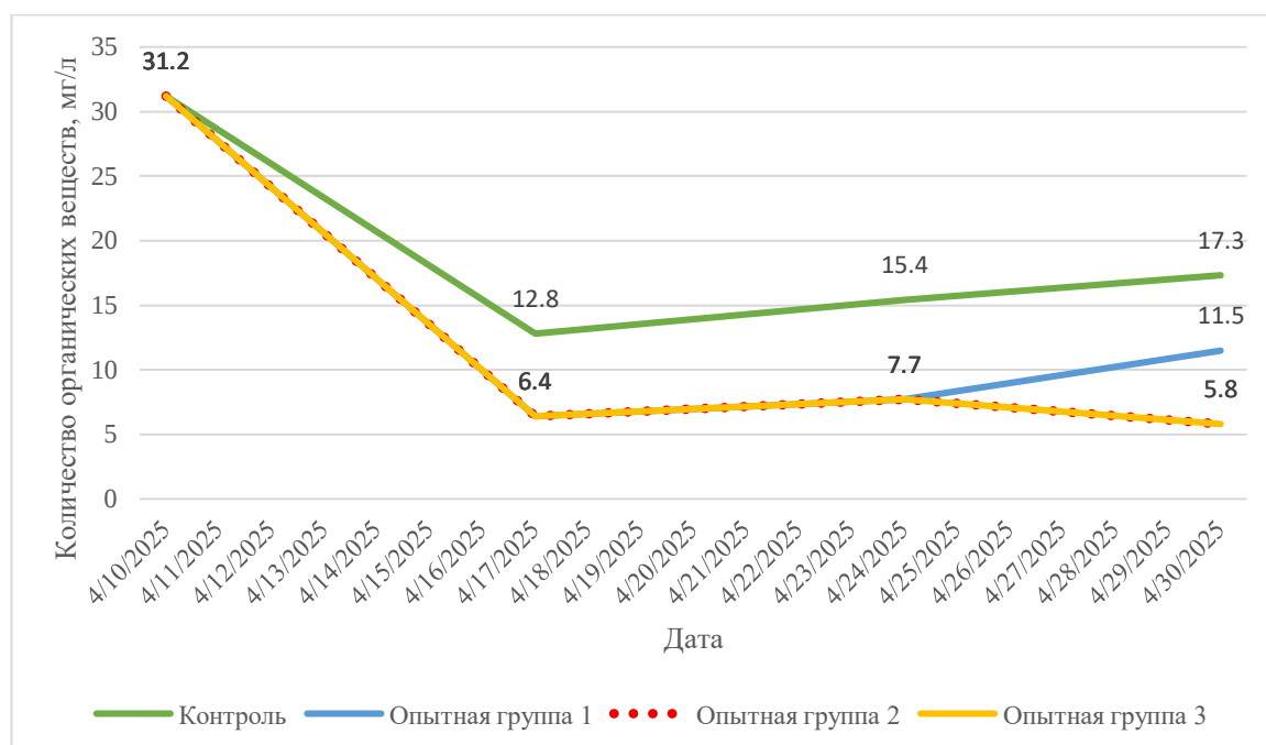
Рисунок 10 – Динамика деструкции органических веществ в экспериментальных пробах с 10.04.2025 по 30.04.2025
