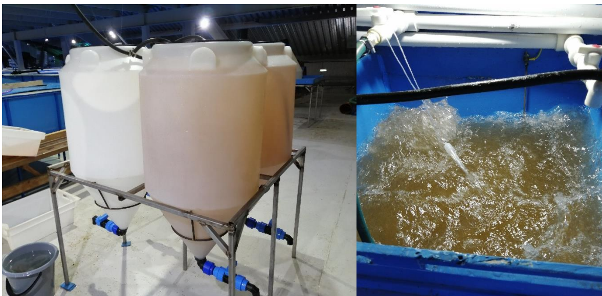
Рисунок 13. Аппараты для хранения живых личинок артемии перед кормлением. Фото их архива автора.
