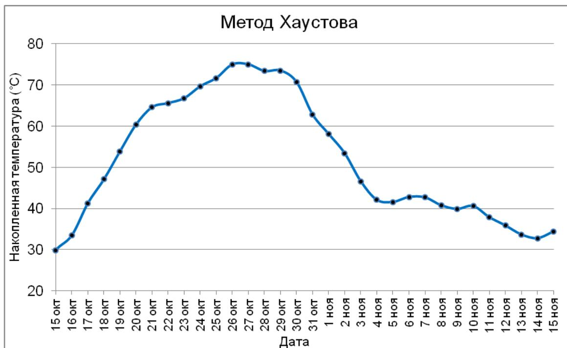
Рисунок 3.2 – График накопленных температур (метод Хаустова) при расчете начала зимнего сезона в городе Пермь
