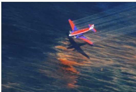
Рисунок 2.11. Распыление диспергентов с самолета [27].
