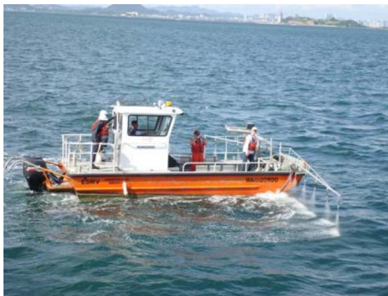
Рисунок 2.12. Распыление диспергентов с суда [28].
