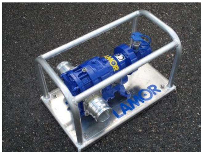
Рисунок 3.7. Нефтеперекачивающий Насос VX 100-64Q [36].
