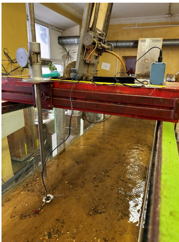
Рис. В2 Измерение скорости потока вертушкой до сужения русла
