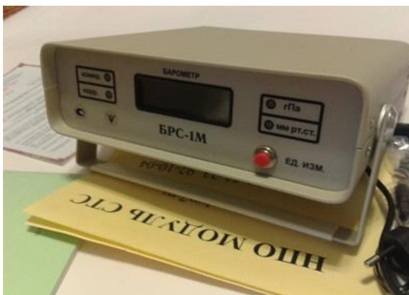
Рисунок 3.7 – Барометр сетевой БРС-1М-1
