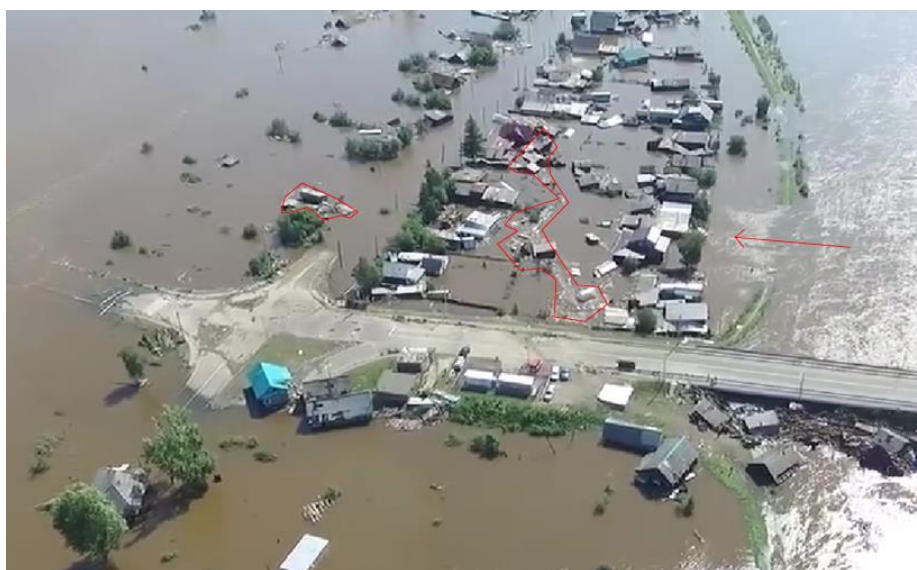
Рисунок 12. Мусорные заторы и движение потоков воды при наводнении в г. Тулун
