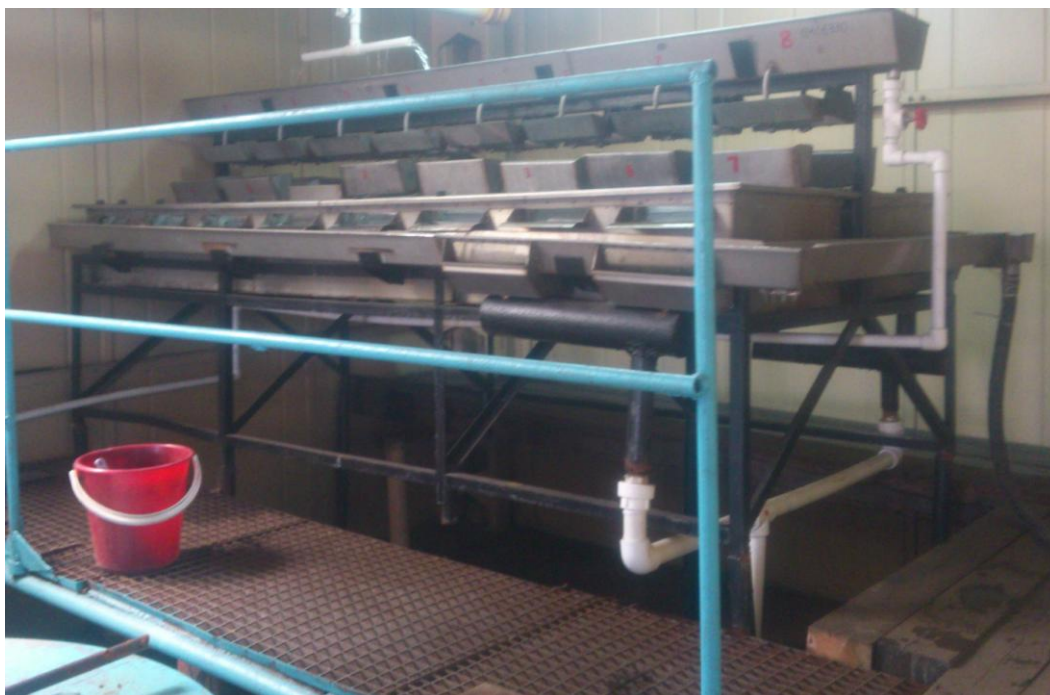
Рисунок 1. Фотография инкубационного аппарата «Осетр» Гусиноозерского осетрового рыбоводного хозяйства. Конец июня 2015г.
